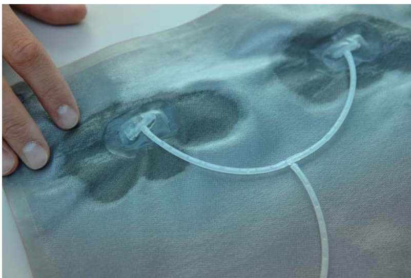
Prototyp eines Laminats wird mit Wasser befüllt. (Bild: Empa)
